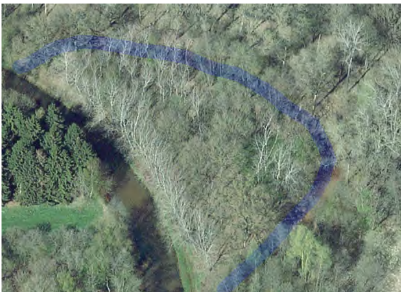
Bestaande meander (rechts) welke wordt aangesloten op de nieuwe loop van de Groote Beerze.
