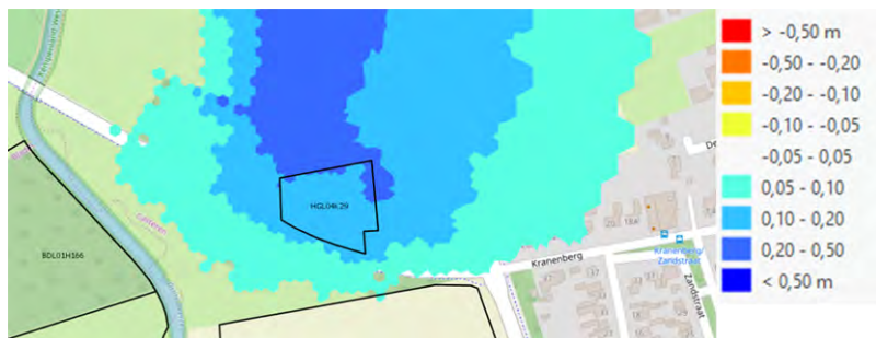
Vershil grondwater huidige GHG en GHG na uitvoering
